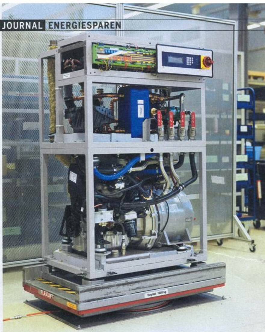
Das „Zuhausekraftwerk“ basiert auf einem ganz normalen Vierzylinder-Motor und wird mit Gas betrieben
